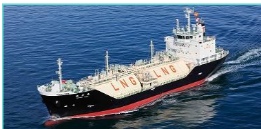
Small LNG carrier cargo capacity 2,500 m 3
