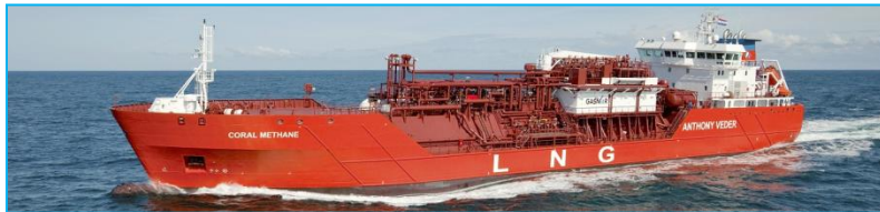
Small LNG carrier cargo capacity 7,500 m 3
