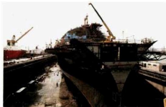
La nave metaniera GOLAR FROST a Dubai nel corso dei lavori di trasformazione nel terminal FSRU Toscana (per g.c. OLT).
