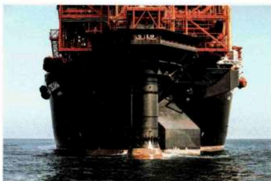
Particolare della torretta d'ormeggio del terminale FSRU Toscana vista da prora (per g.c. OLT).
