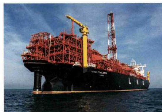
Il terminale FSRU Toscana ormeggiato al largo di Livorno, visto da prora; in primo piano la torretta di ancoraggio e il modulo di rigassificazione (per g.c. OLT).
