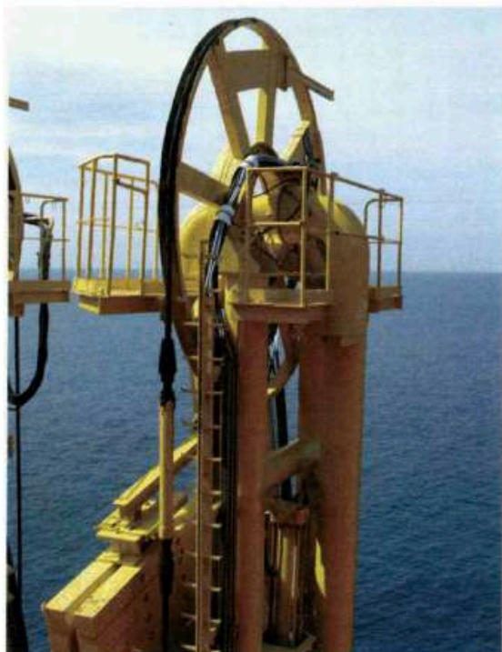
Particolare di un braccio di carico del terminale FSRU Toscana (per g.c. OLT).
