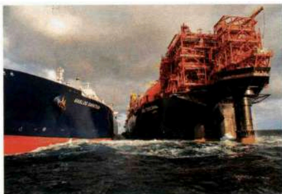
Un'altra immagine della GASLOG SARATOGA ormeggiata alla FSRU Toscana nel corso delle operazioni di scarico di GNL (per g.c. OLT e GasLog LNG Services Ltd).
