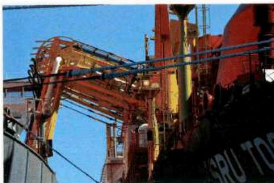
I quattro bracci di carico della FSRU Toscana durante il trasferimento di GNL da una nave metaniera al terminale di rigassificazione (per g.c. OLT).
