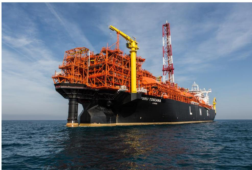
**OLT Offshore LNG Toscana S.p.A.** ha sviluppato e realizzato il Terminale di rigassificazione “FSRU TOSCANA”, del quale detiene la proprietà e la gestione. Il Terminale è stato posizionato al largo delle coste toscane, a 22 km di distanza, ed è collegato alla terra ferma da una condotta, necessaria all’invio del gas naturale alla rete di distribuzione nazionale italiana.
