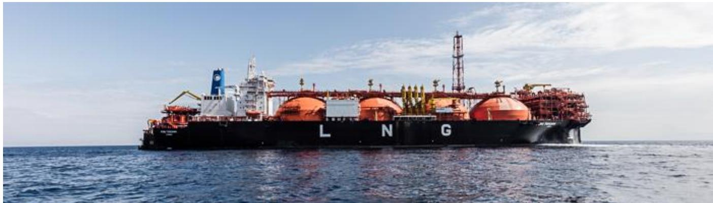
**OLT Offshore LNG Toscana S.p.A.** ha sviluppato e realizzato il Terminale galleggiante di rigassificazione FSRU Toscana, del quale detiene la proprietà e la gestione commerciale.
